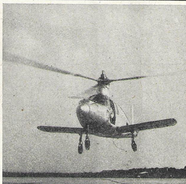
Einen Hubschrauber , der nach dem Start als gewöhnliches Flügelflugzeug weiterfliegt, entwickelte die SNCASO, Frankreichs zweitgrößte, mit Marshall Plan Hilfe entwickelte Flugzeugfabrik.
