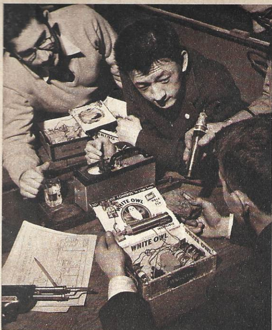
Zur Leidenschaft wird bei manchen Schülern das Basteln von Geigerzählern. Oft sind sie einfach in einer Zigarettenschachtel eingebaut, zuweilen aber ist die Ausführung ganz fachmännisch (Mitte).
