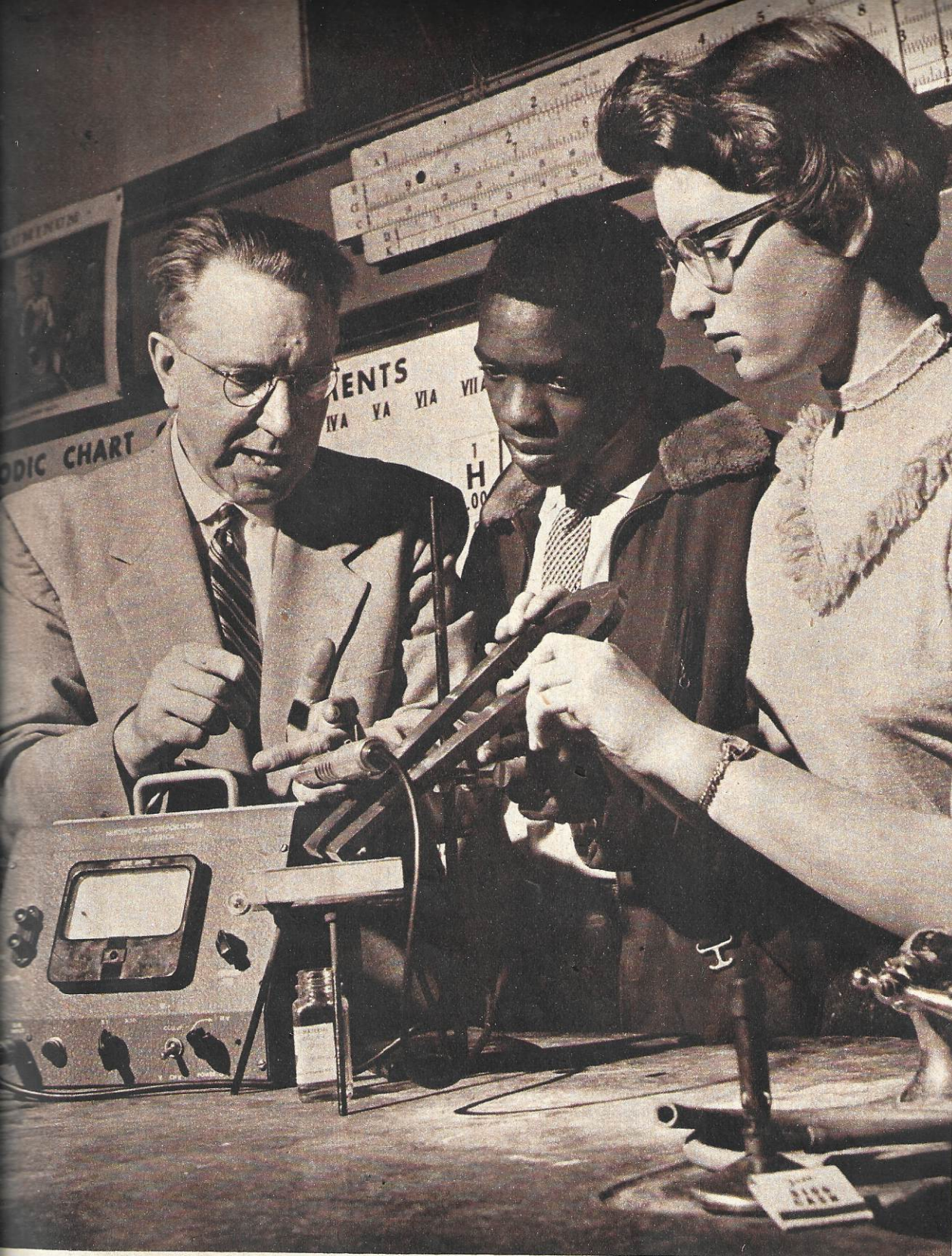
Kleine Atomlaboratorien wurden in den Physiksälen vieler Schulen in den USA eingerichtet. Hier beweist der Lehrer seinen Schülern mit Hilfe eines Geigerzählers die Ablenkung der von einer radioaktiven Substanz (im Fläschchen) ausgesandten Alpha- und Betastrahlen in einem Magnetfeld.
