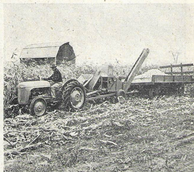
Eine Mäiserntemaschine bei der Arbeit. Sie pflückt die Kolben, enthüllt sie und lädt sie mit einem Förderband auf einen Anhänger.
