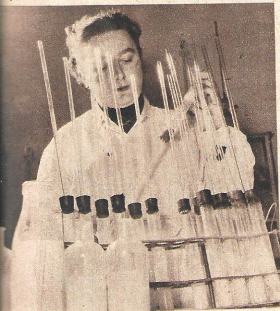
Wasser in der Milch kann im Laboratorium nachgewiesen werden, weil dadurch die Lichtbrechung des Milchserums verändert wird. Hier werden Milchproben aus verschiedenen Betrieben kontrolliert.
