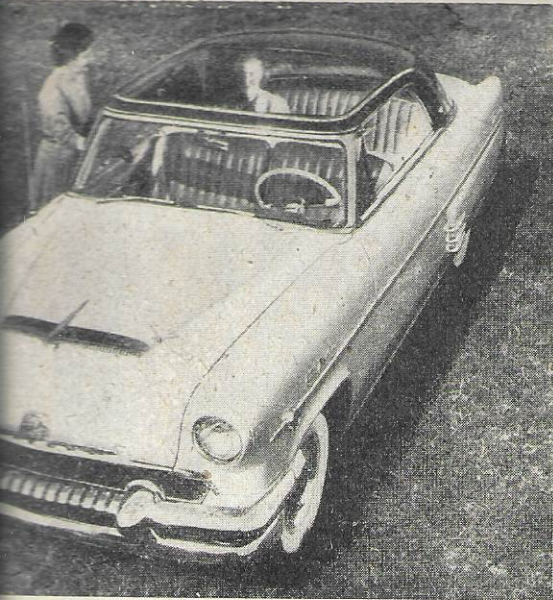
mit Aussichtsdach brachten kürzlich die amer- Mercury-Werke auf den Markt. Das Dach ordersitzen besteht aus durchsichtigem Kunst- Schutz gegen Sonnenblendung ist es grünetönt.
