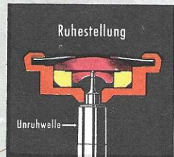
Querschnitt der Junghans-Stoßsicherung in starker Vergrößerung.
