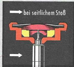
So schützt die Junghans-Stoßsicherung bei seitlichen und axialen Stößen die Zapfen und Steine der Unruh wirksam gegen Bruch.
